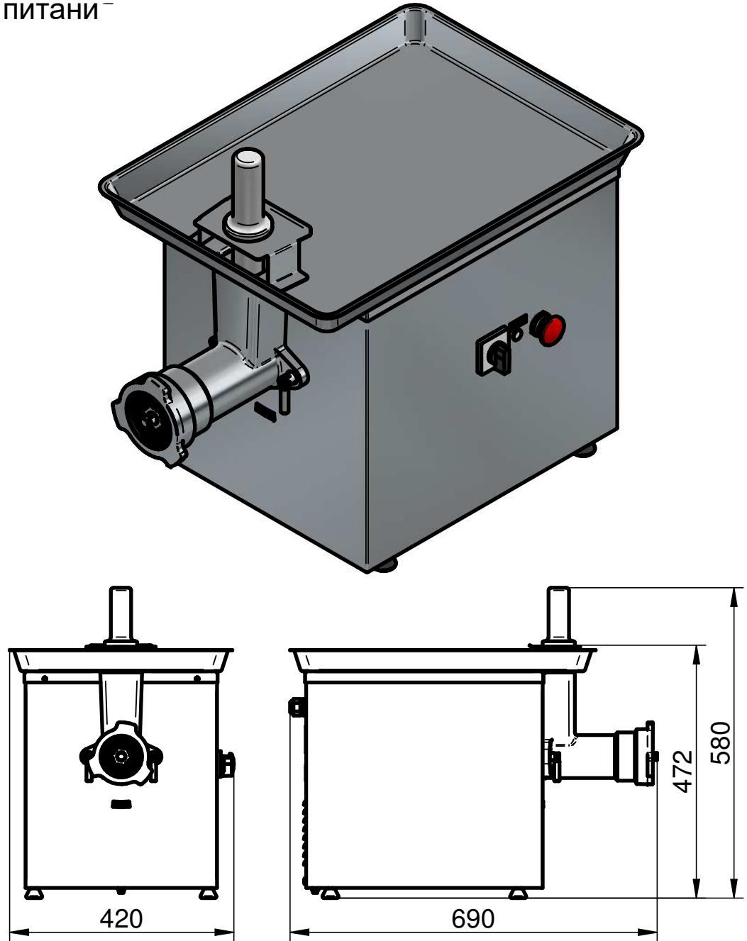
Для изготовления кожуха, лотка, корпуса, шнека и гайки применяются высококачественные нержавеющие стали.
